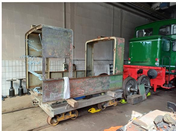
Die Motorhaube der DL4 wird derzeit geschliffen.
