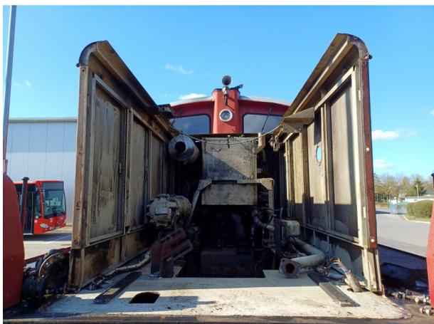
Blick in den vorübergehend leeren Motorraum der Diesellok V22 während des Motortauschs.
