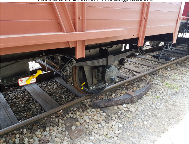
Die Tauschfedern sind montiert am G 154 "Oppeln", aber
