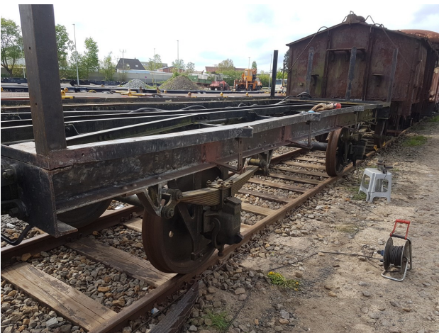
Angeschliffener Langträger am Flachwagen Gw 102 ex Kleinbahn Bremen-Thedinghausen.
