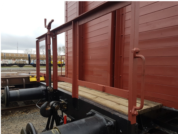
Handbremse und Trittbretter montiert am "Oppeln" G 154
