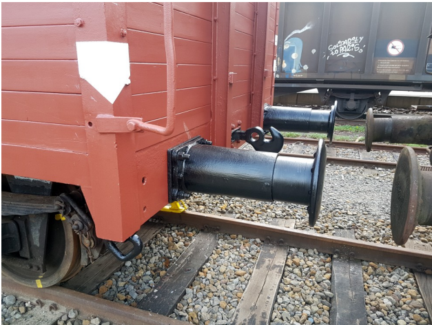
Restaurierte Puffer montiert am Verdener Ende von G 154.
