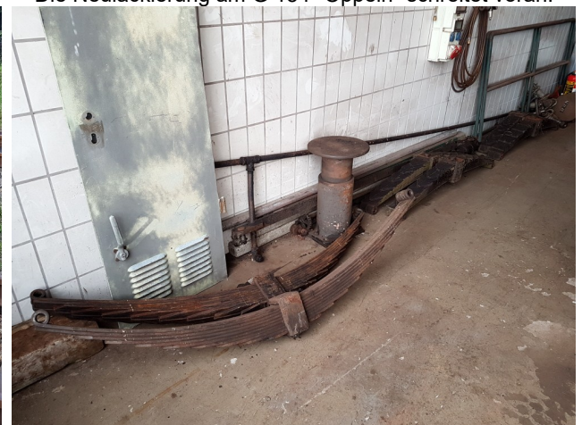
Gehen zur Aufarbeitung: Federn für Wagen 67 und 154.
