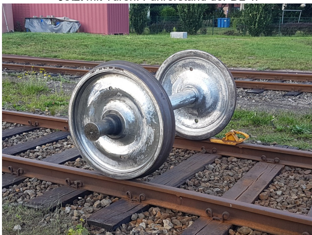
Für Rissprüfung geschliffen: Tauschradsatz für Wagen 67.
