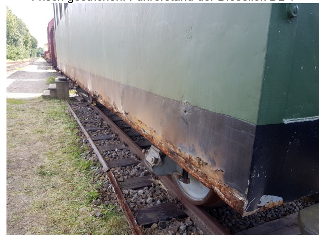
Frisch freigelegt: Roststellen am Wagen 67
