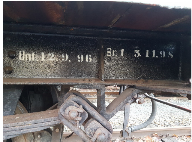
Die historische Beschriftung am "Oppeln" 154 wird vor dem Abschleifen und Entrosten fotografisch dokumentiert.
