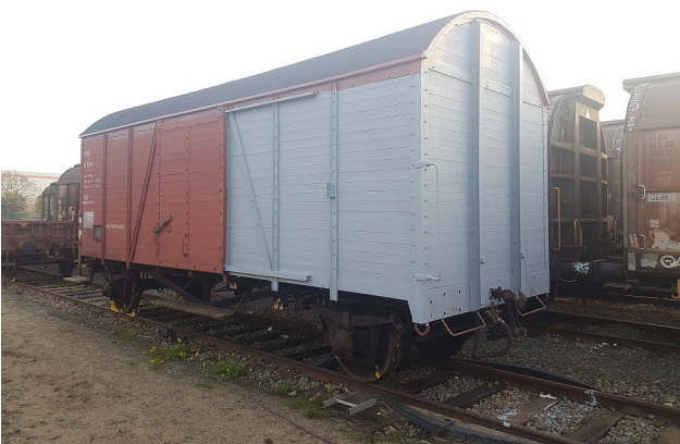
"Oppeln" G 154 mit neuer Dachhaut und Grundierung.
