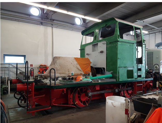
"Richtfest" bei DL 4: Der Motorblock ist eingebaut, weitere Arbeiten werden folgen.
