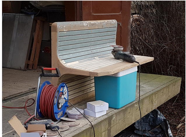
Der Rest der Farbe muss in mehreren, immer feiner werdenden Schleifdurchgängen abgeschliffen werden.
