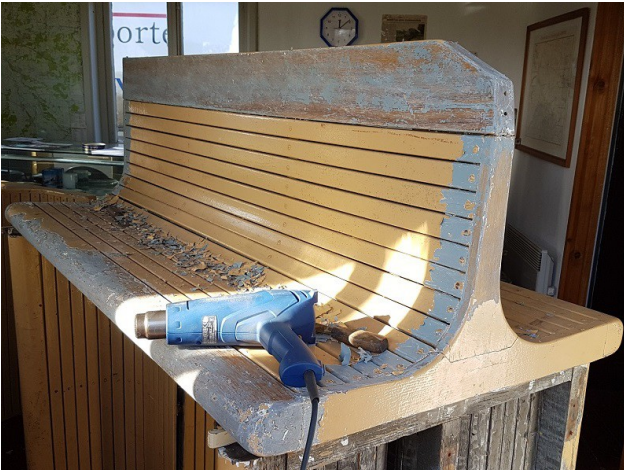
Mit Heißluftbläser und Spachtel ließen sich die äußeren Farbschichten bis zur Grundierung recht gut lösen.
