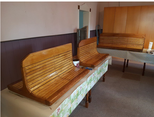
Die einbaufertigen Sitzbänke nach dem Lasieren.
