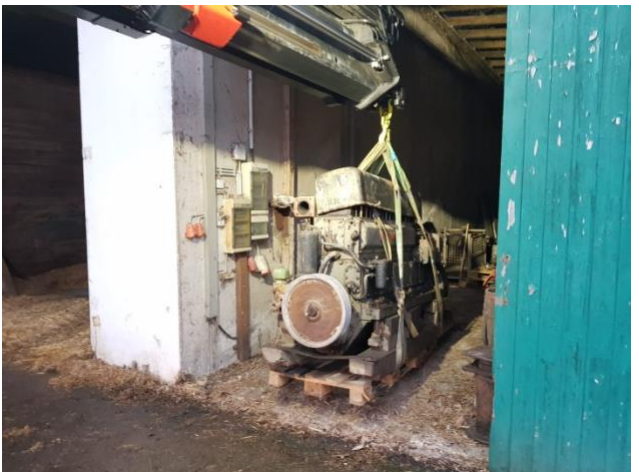
Für die Deutz-Diesellok 2 wurde ein Ersatzmotor der Ursprungsbauart A6M 220R beschafft und eingelagert.
