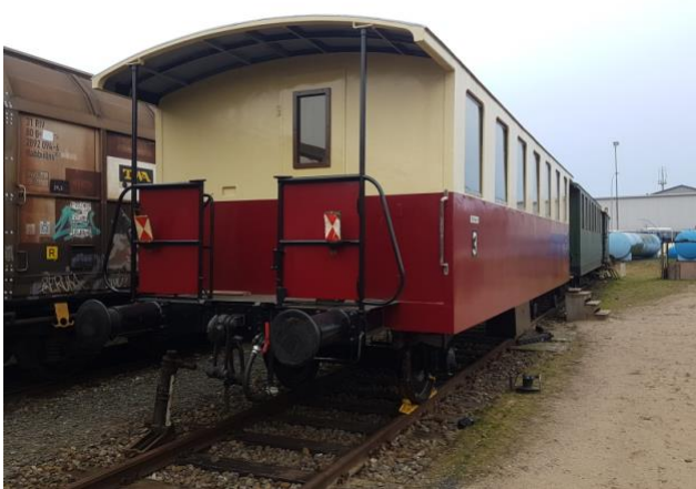
Das Äußere des Wagens Ende Dezember: Die 2. Stirntür ist montiert, die Bühnengitter folgen diese Tage.
