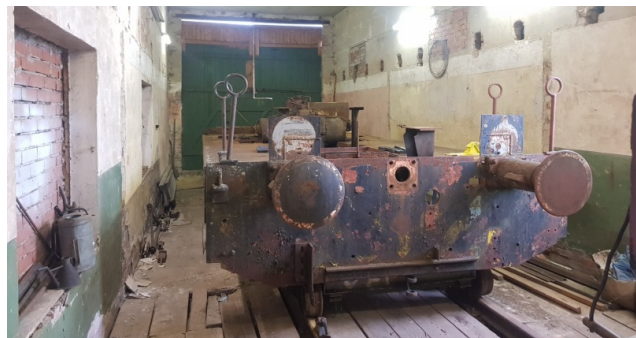
Der Lokrahmen steht jetzt geschützt und bereit für weitere Arbeiten auf Robelachsen im Lokschuppen in Stemmen.
