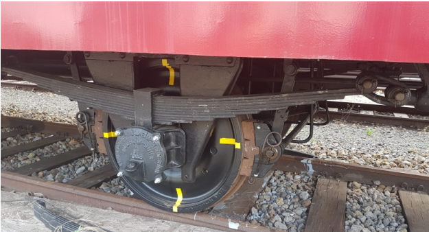
Eine Achse am Wagen 55 "Leester" ist jetzt samt Federn und Bremsen beinahe fertig montiert.
