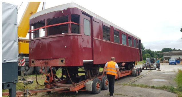
Auf einem Straßentiefelader verzurrt geht es in die neue bzw. alte Heimat nach Lüneburg.
