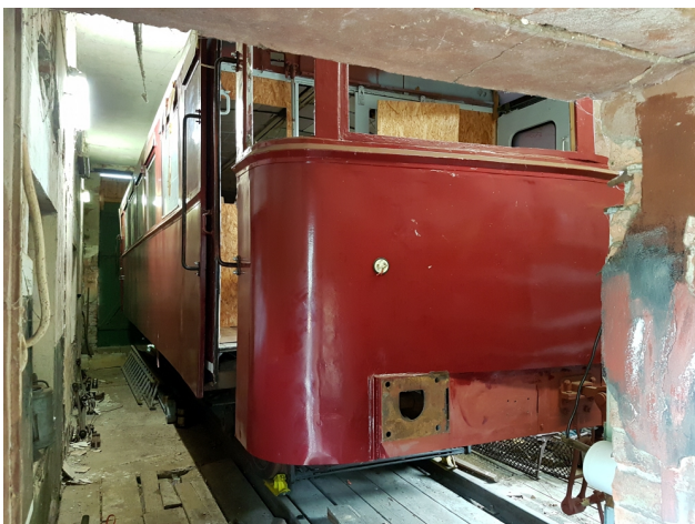
Beiwagen TA 0350 transportfähig hergerichtet ohne Tritte und Stirnfenster für den Abtransport nach Lüneburg.
