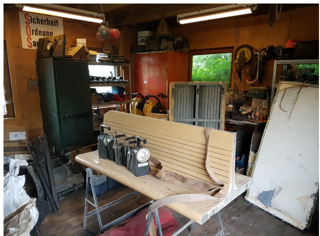
Die letzten Wandbleche und ersten Sitzbänke vom "Leester" Nr. 55 zum Schleifen in der Stemmer Werkstatt.
