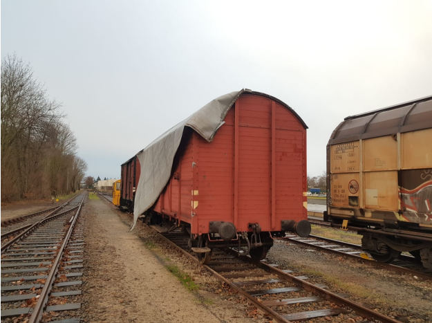
Ärgerlich: Dachhaut am G 154 ist durch Sturm zerstört.
