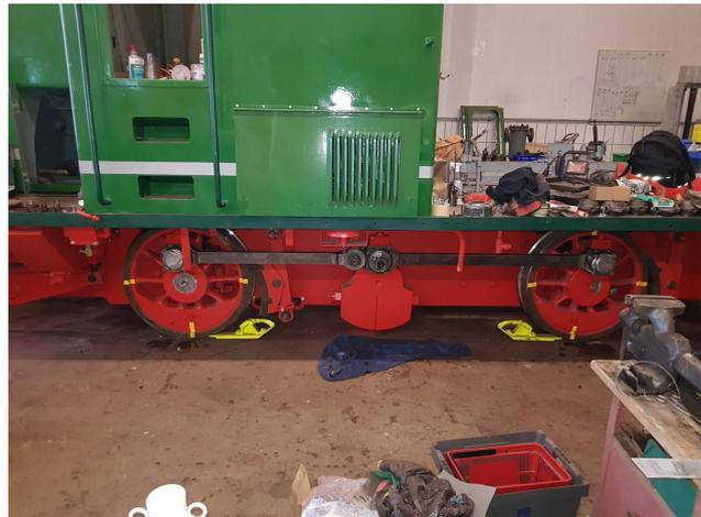
Das Fahrwerk von Diesellok 4 ist fast fertig montiert.
