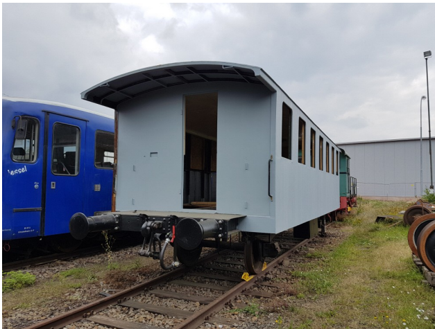
Die fertige Seite von Wagen 3: Die Puffer sind montiert.
