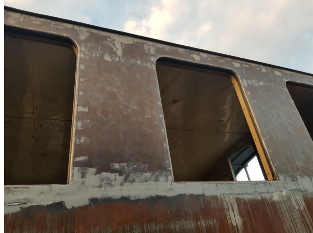
Bereits teilweise gespachtelt: Wagenseite 2.
